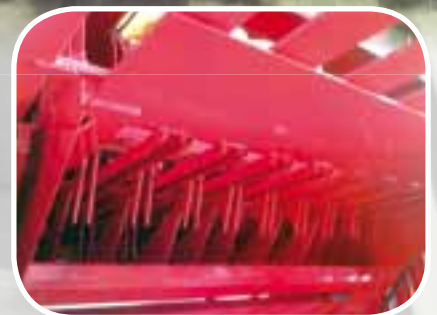
Dosatore a 3 rotori con tappeto scarico bilaterale in PVC e 9 coltelli su convogliatore di carico. Dosing device with 3 rotors and bilateral unloading belt in PVC with 9 knives on the loading conveyor.
