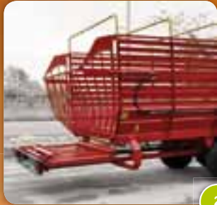
Scarico bilaterale con tappeto retrattile per i modelli: CA60-CA70-CA70S MEGA 35 e MEGA 40 Bilateral unloading with retractable belt for models: CA60-CA70-CA70S MEGA 35 and MEGA 40
